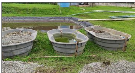
Figura 4 – Estanqueidade dos SACs
