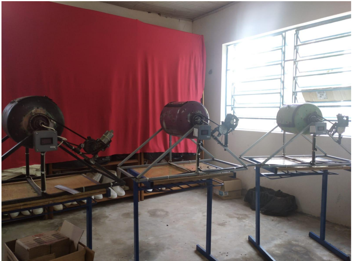
Figura 2 – Composteiras giratórias e aquecidas tendo como fonte energética um sistema fotovoltaico.
