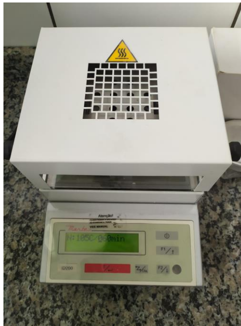
Figura 7 – Analisador de Umidade Halógeno
