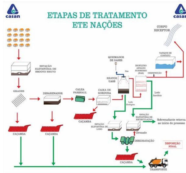
Figura 1 – Etapas de Tratamento ETE Nações
