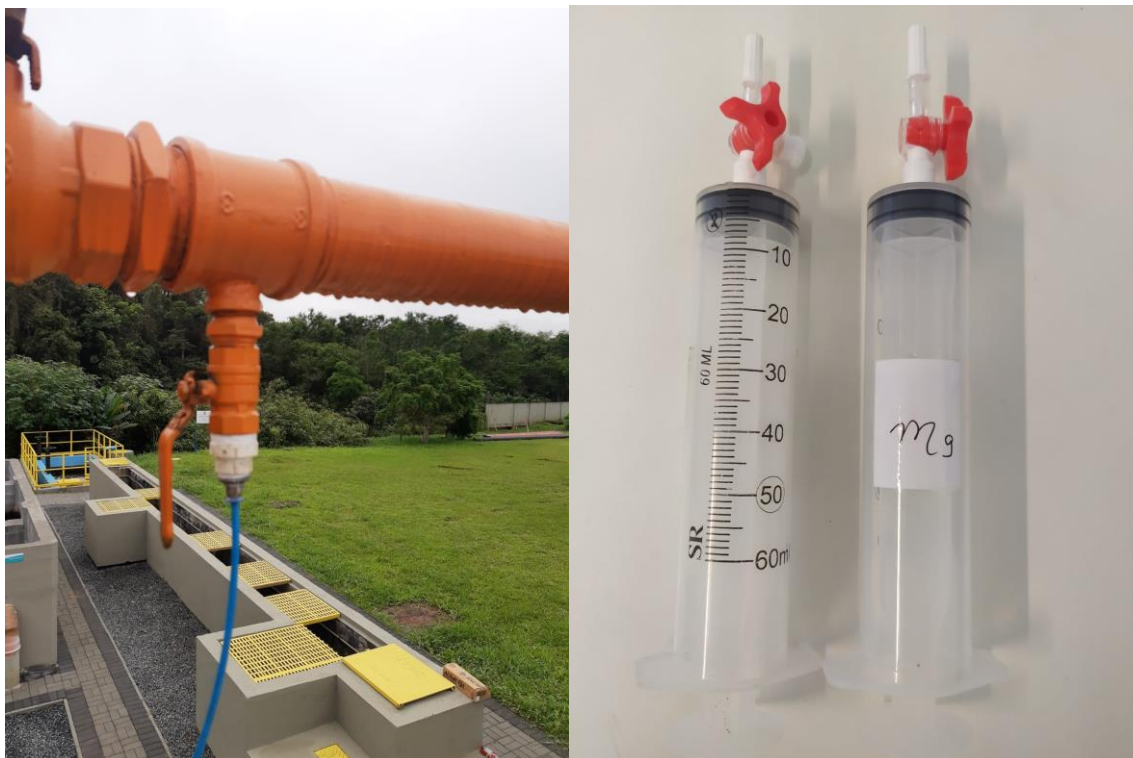
Figura 2 – Ponto de amostragem biogás e seringa utilizada para coleta
