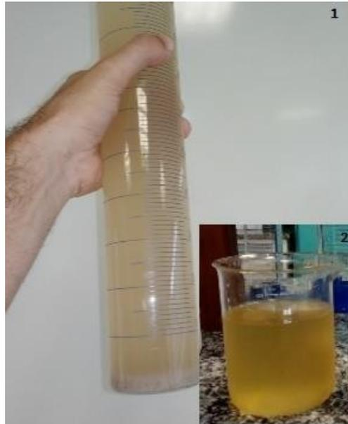
FIGURA 18: Extrato após relargagem com etanol 96,8°GL e tratamento com carvão ativo (1). Resíduo de matéria insolúvel decantada. Material filtrado com 2 g de carvão ativado (2).
