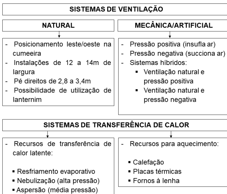
Figura 3 - Sistemas de ventilação e transferência de calor utilizados na suinocultura brasileira.
